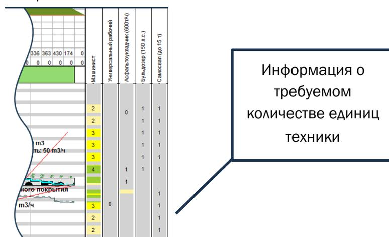
Рис. 4 Профиль загрузки ресурсов на циклограмме.
